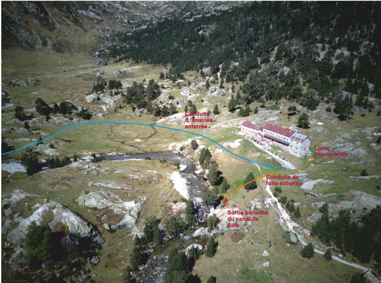
Figure 22 : Vue aérienne du refuge et des tracés enterrés des conduites d'amenée et de fuite
